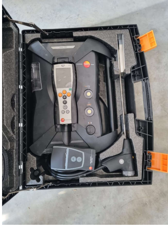
Şekil 7: Testo 350 baca gazı analiz cihazı
